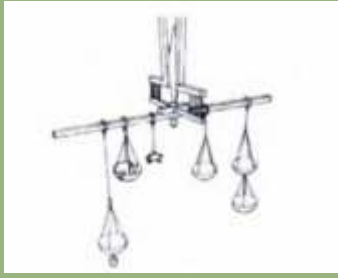
Biruni'nin cisimlerin öz kütlelerini ölçmek için kullandığı bir terazinin çizimi.
